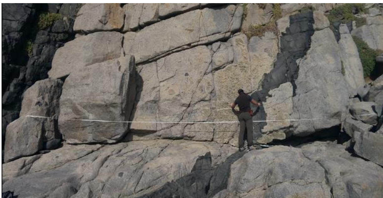
Figura 74 - Scan-Line Cala Delfino Unità Geomeccanica U2.
