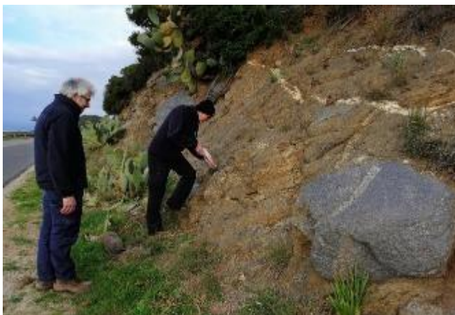
Figura 59 – Misure sclerometriche
