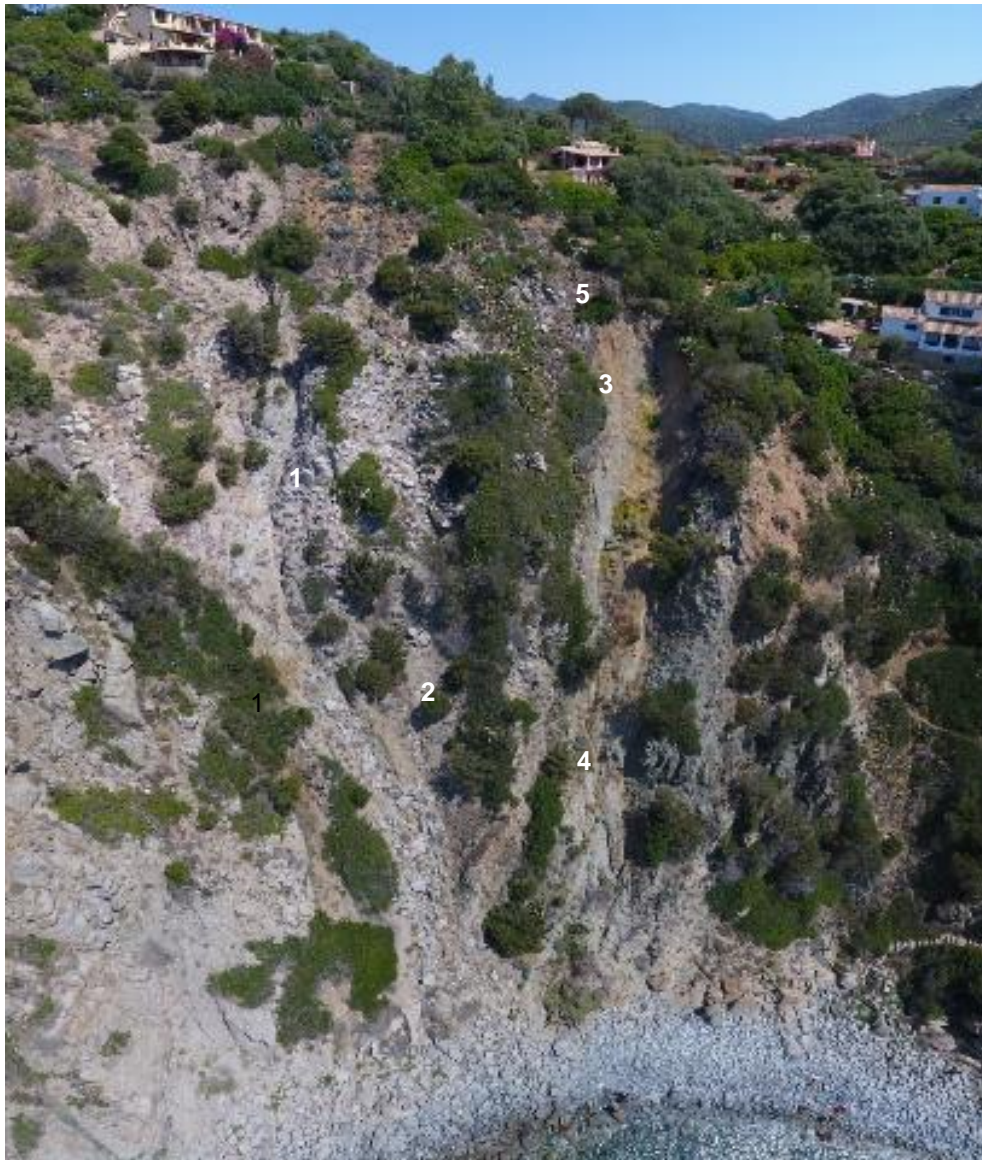
Figura 11 - Immagine acquisita da drone. In evidenza: 1- canale erosivo associato a scariche di detrito (2); 3 canale erosivo con deposito di colata basale (4); 5 - area di testata con tendenza evolutiva retrogressiva.
